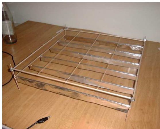
Лифтер с параллельными коронирующими проводами, разнесёнными на 1.3d
